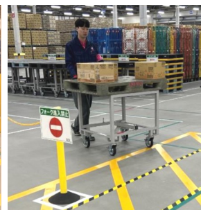
パレット台車を使用することでスムーズな移動が可能（衝突リスク軽減）
